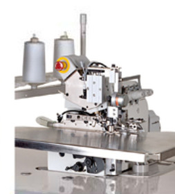
ASK-ESG100 牛仔褲前檔自動包邊機 Jeans Fly-facing Auto-Serging Machine
