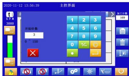
在主控界面点击
