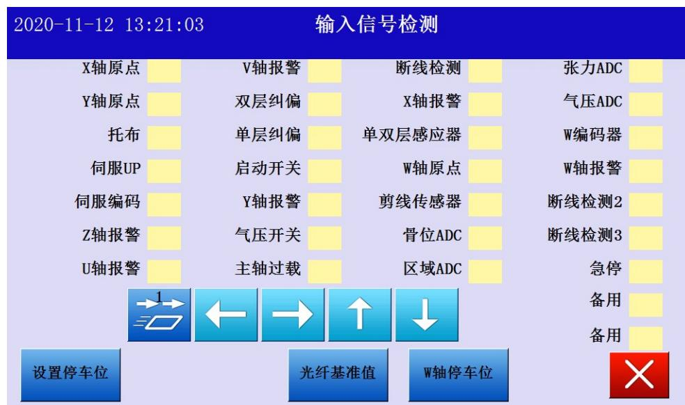
依次改變各個感應器狀態，看此介面上的顯示框裡是否有變化。如果沒有，檢查信號介面板，感應器是否正常。如果有變化，確認感應器是否裝在介面上顯示框所描述的位置。
