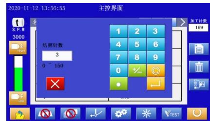
在主控界面点击
