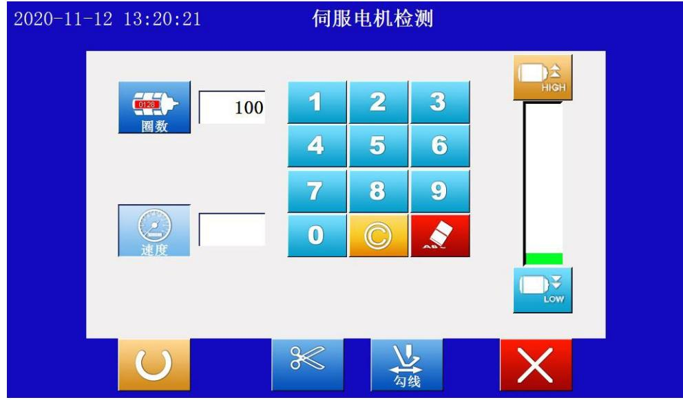
數位鍵輸入運行圈數，進度條一側輸入運行速度，點擊運行鍵測試主軸是否正常運轉。
