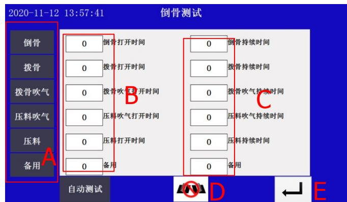
A. 點擊按鍵可以改變倒骨功能各個氣缸的狀態值。
