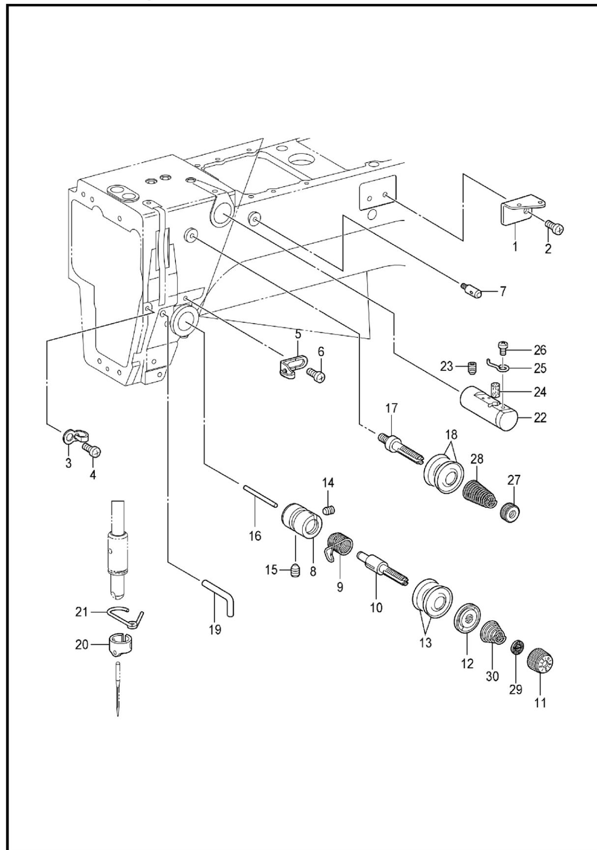
G. 穿线装置 / Threading mechanism
