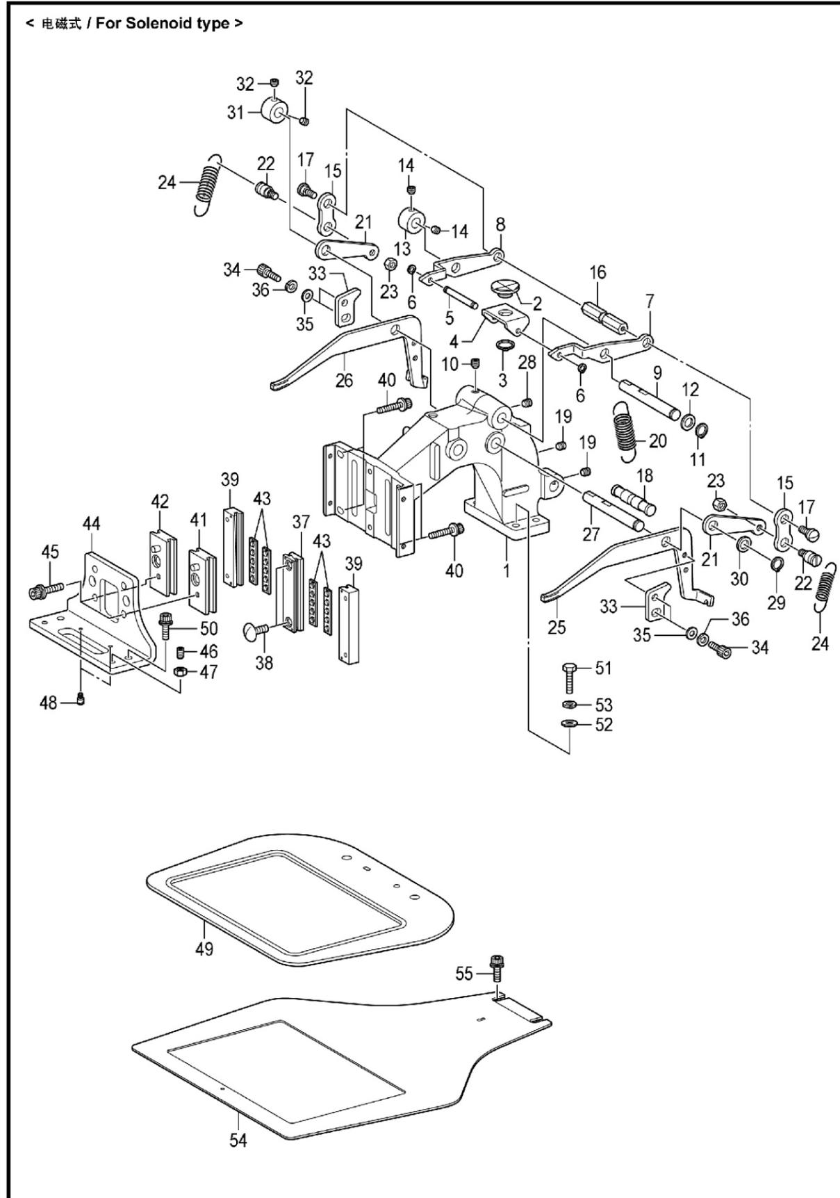
C3. 送料装置 / Feed mechanism
