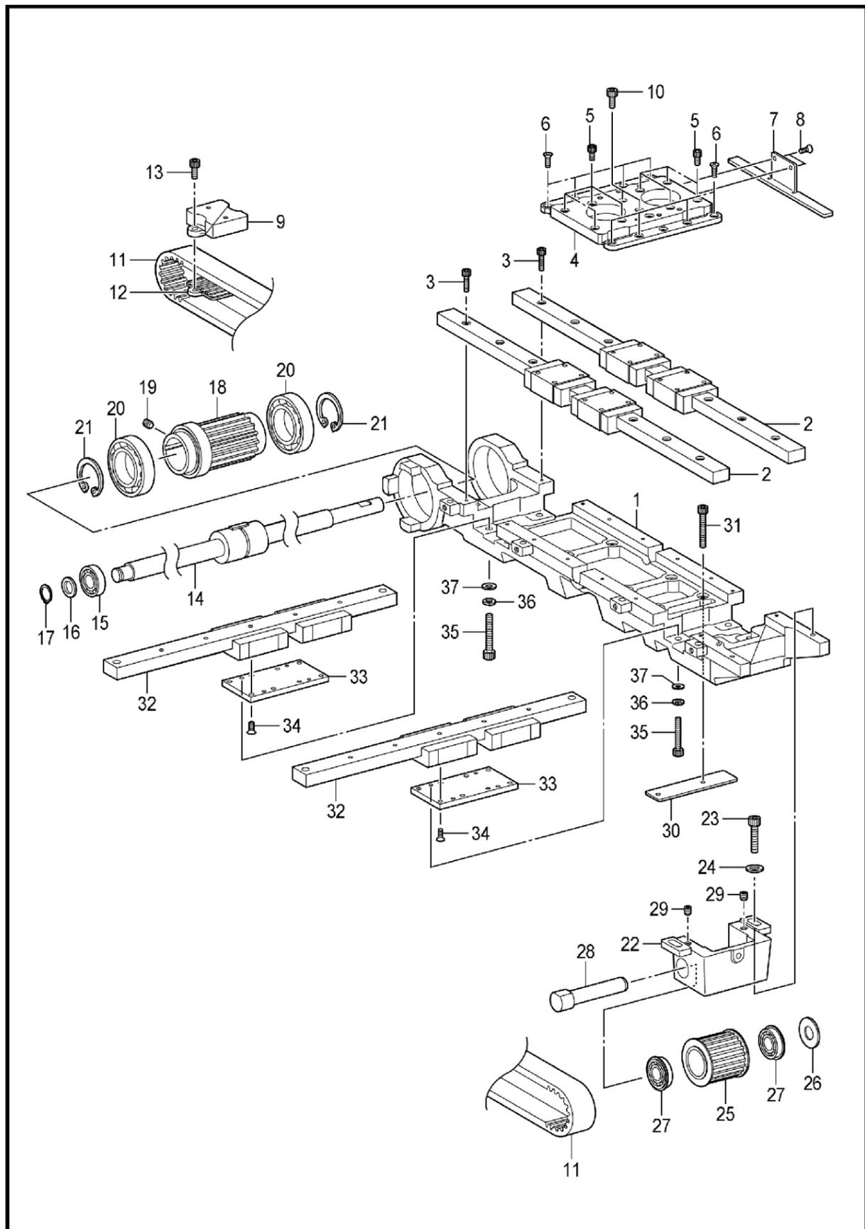
C1. 送料装置 / Feed mechanism
