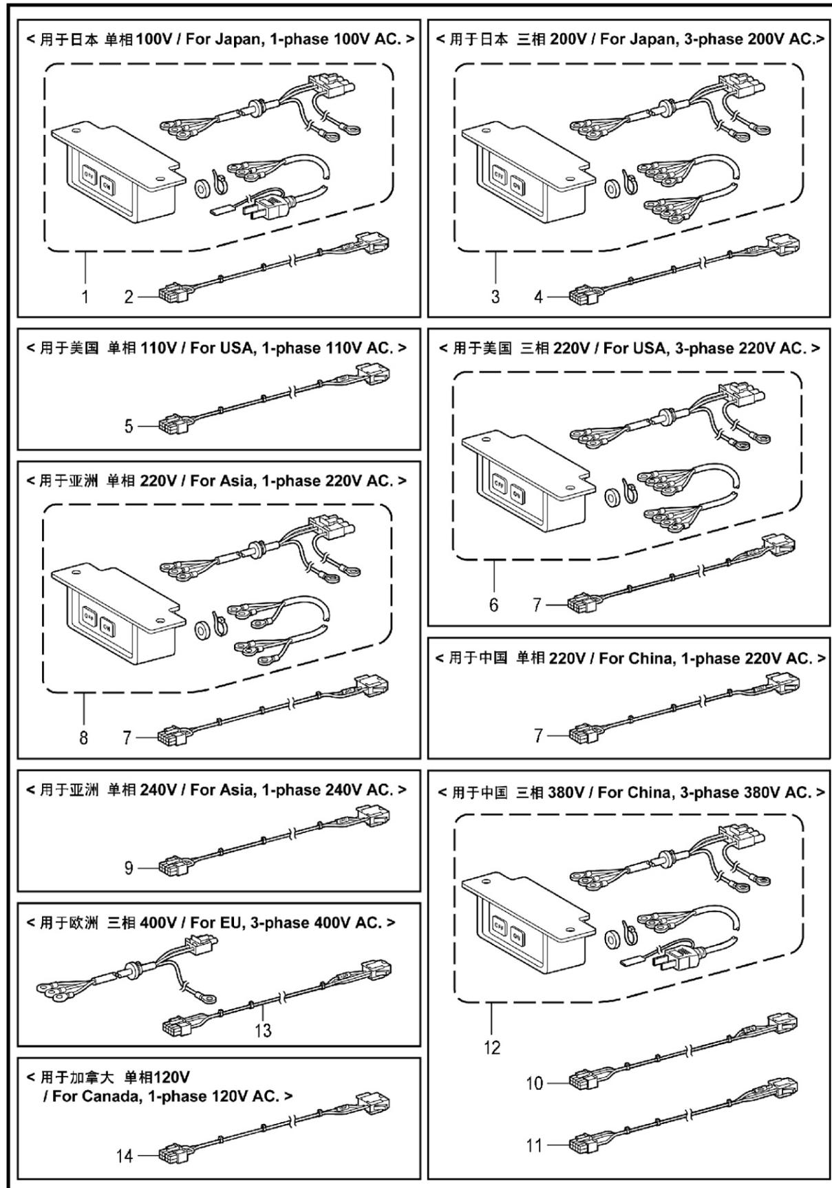
N. 开关装置 / Power switch mechanism
