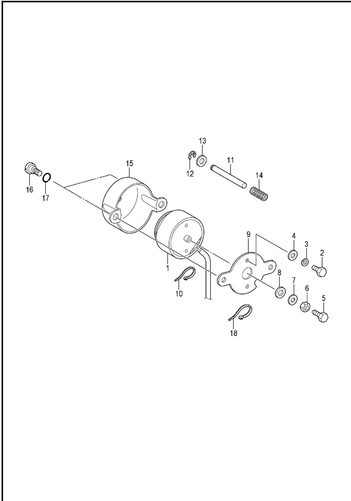
L. 松线装置 / Tension release mechanism
