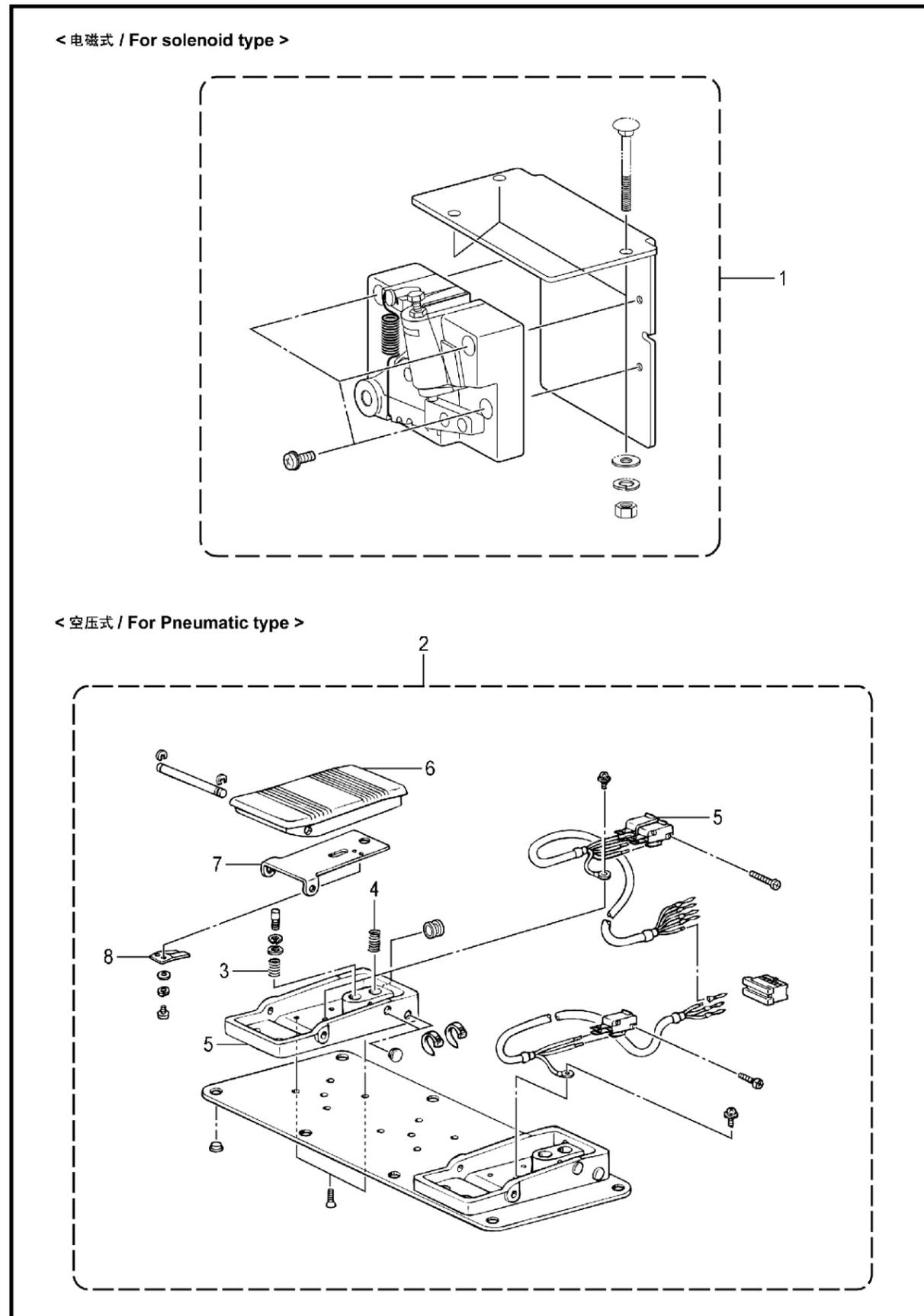
T. 踏板关系 / Foot switch pedal mechanism
