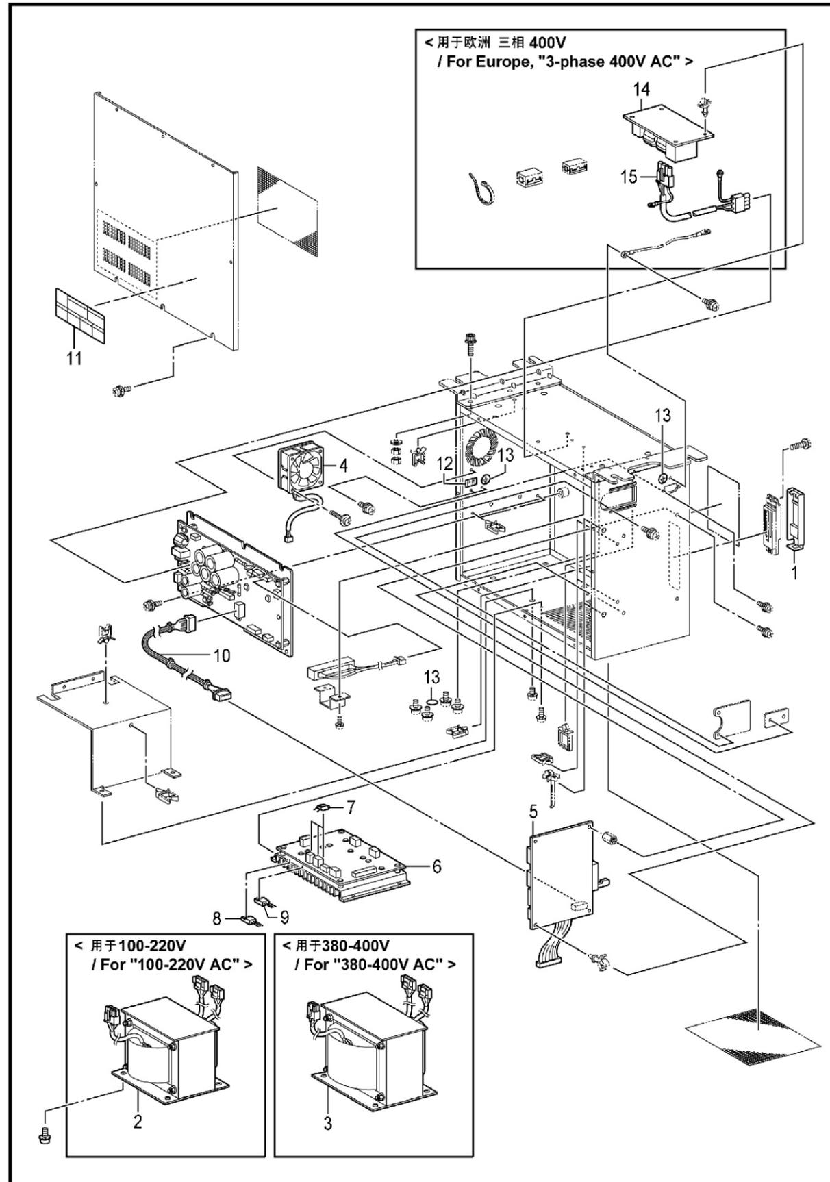
M1. 控制箱装置 / Control box mechanism
