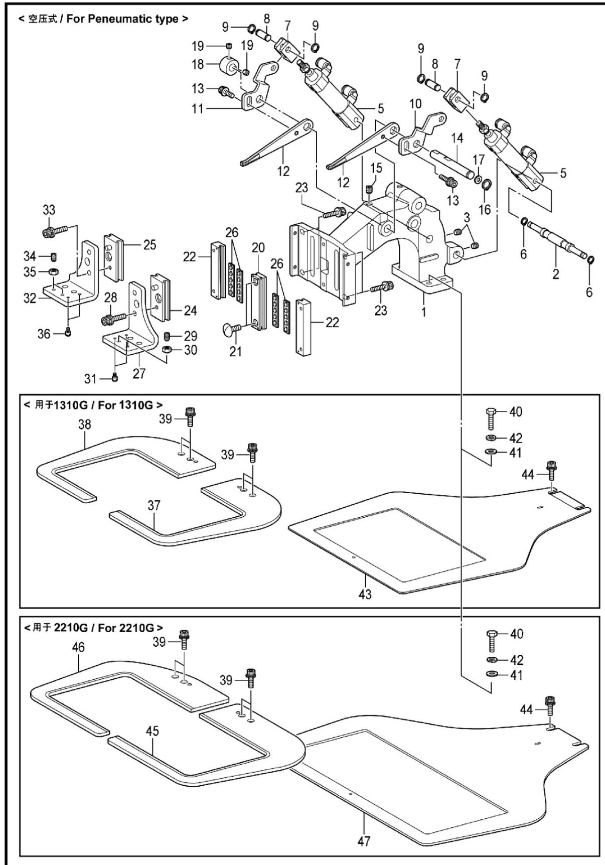
C4. 送料装置 / Feed mechanism
