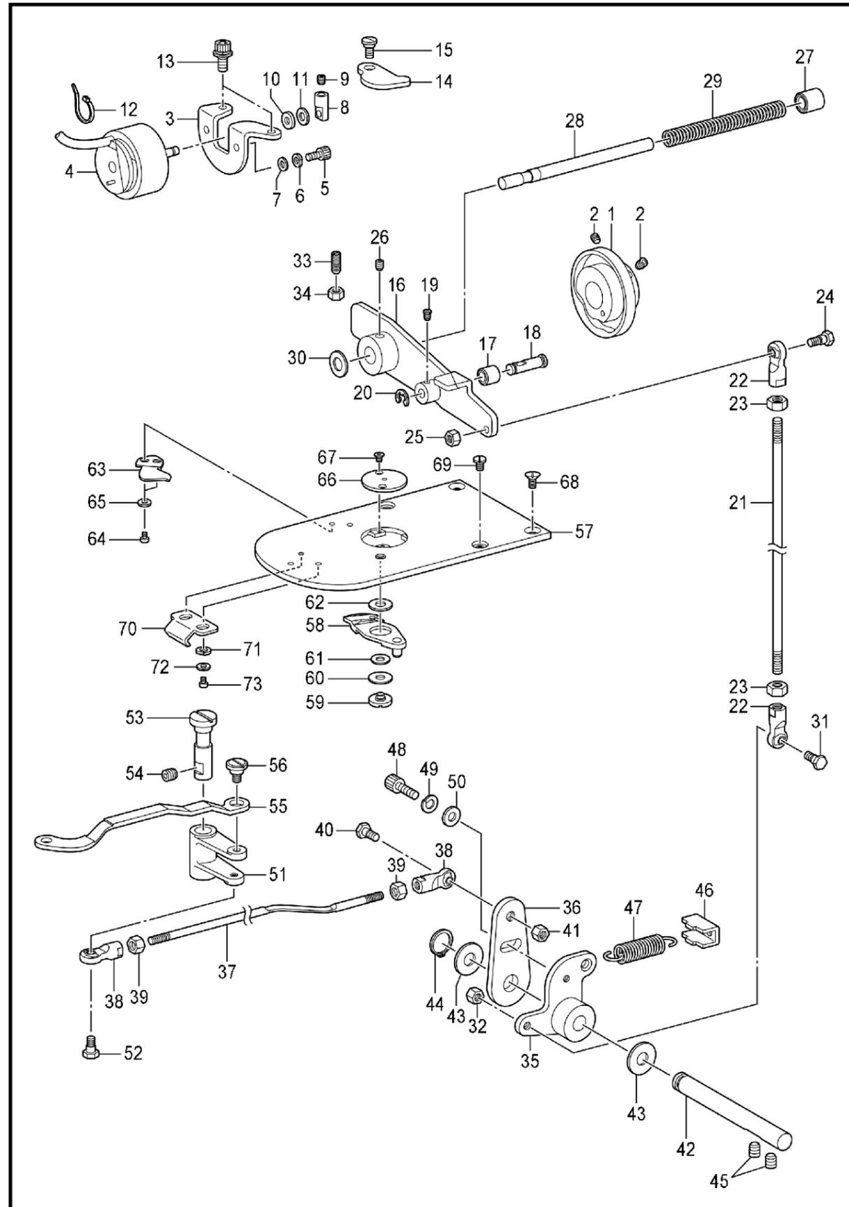
J. 切线装置 / Thread trimmer mechanism
