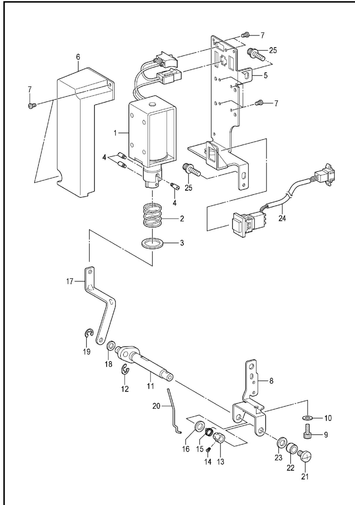
K. 扫线装置 / Thread wiper mechanism
