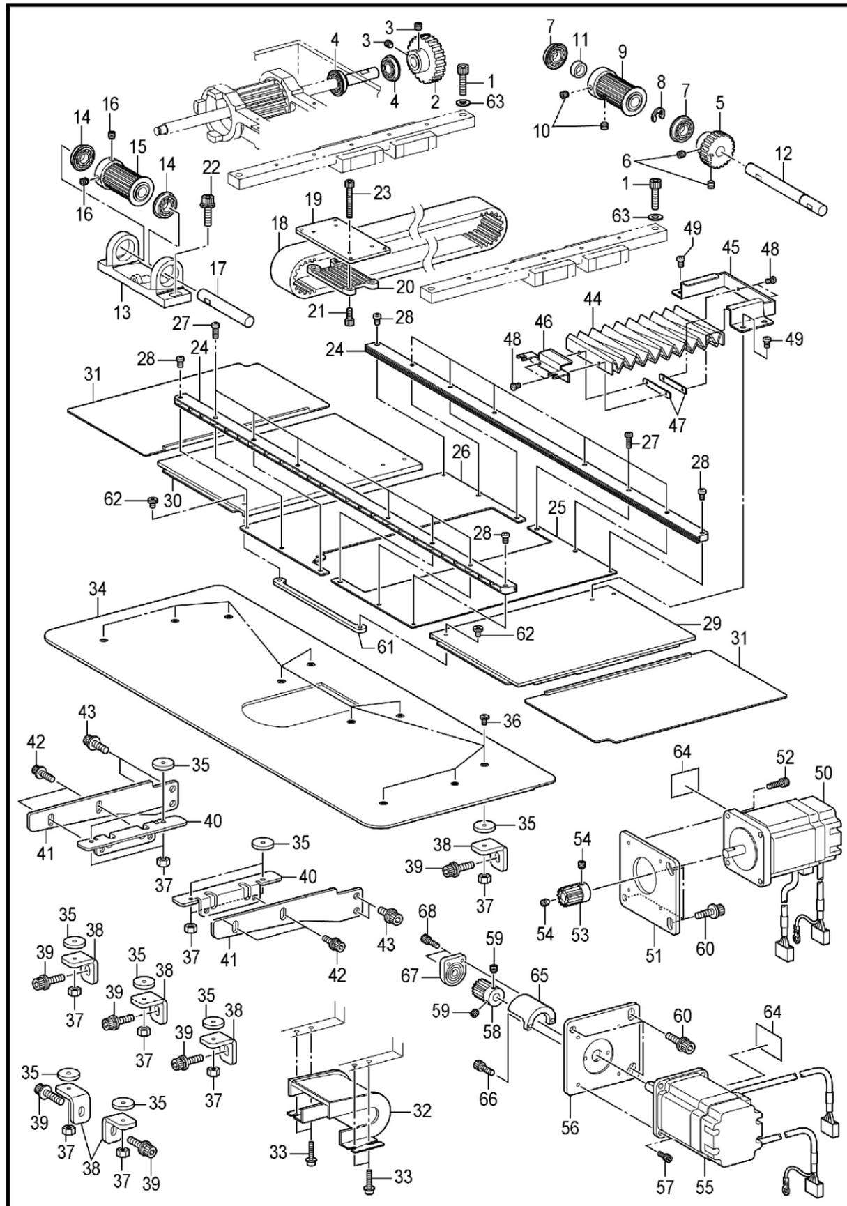
C2. 送料装置 / Feed mechanism
