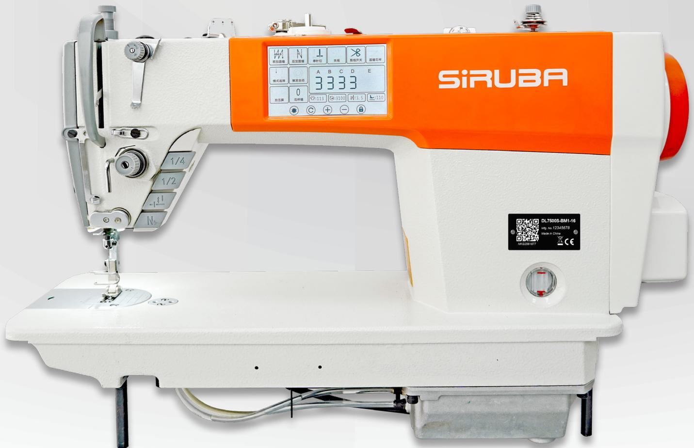
本机采用一体式智能操作系统，配备4.3寸触摸显示屏，简化操作逻辑，参数调整更加便捷。无轴承主轴伺服马达、花样米粒缝、包油盘、电子膝控、短线头等功能，且送布、剪线、抬压脚为步进电机驱动，稳定低噪音，功能齐全，质量稳定。
