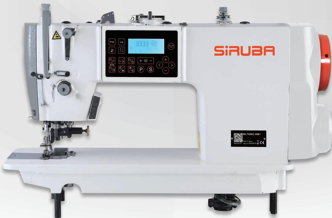
採用內置式直驅伺服馬達，實現了機器的快速啟動和制動的精確度；大幅度降低了噪音和振動，並降低了能耗。與普通的驅動裝置相比，電量耗減35%以上。適用於縫製各類襯衫、西服或類似服裝，特別是其衣領、前襟等部位。高速縫製時倒順送料針距能保持完全一致。側切刀裝置使縫紉和修刀工序一次完成，工作效率提高。
