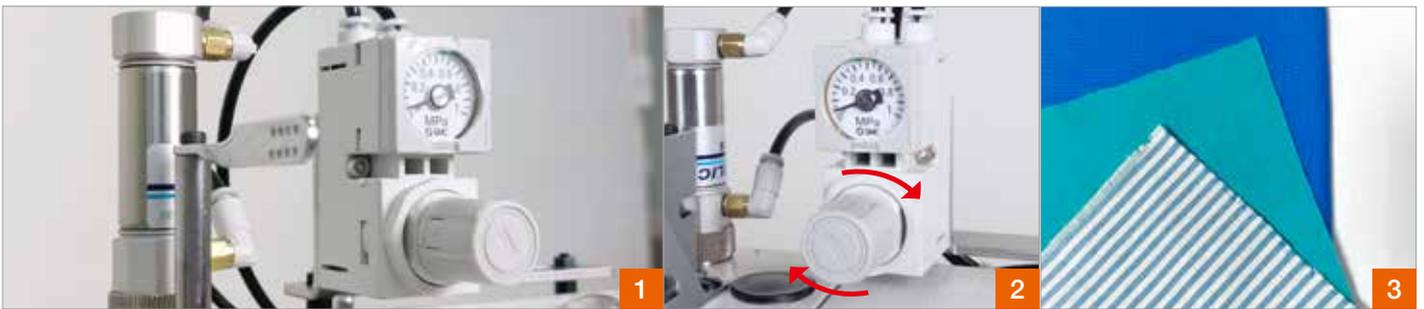
**1** CAF 气动式持压控制装置，运用气动让压脚压力保持在均匀且最低限度的控制下，稳定持压下无论弹性、极薄布料都可即时调整成适合的压脚压力
