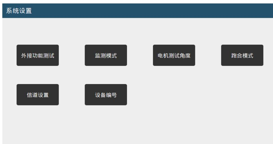
①外接功能測試：包含抬壓腳測試、剪線測試、吸風測試、松線測試，診斷外接功能是否正常。
