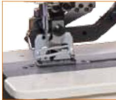
用于各种针织、棉纺、化纤等之物的钮孔锁缝，薄料、中厚料均宜；可缝制平线边与三角线边，线边牢固美观。
