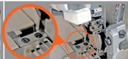
切刀安全感应装置 Cutter safety sensor
